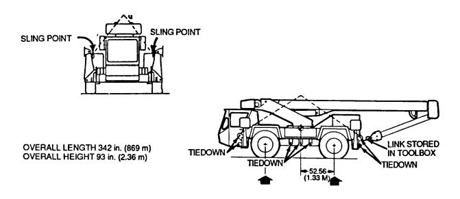
SHIPPING CUBAGE 1,767 cu. ft. (50 cu. m.) OVERALL WIDTH 96 in. (2.44 m)
